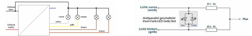
Anschluss für antiparallel geschaltete LEDs
